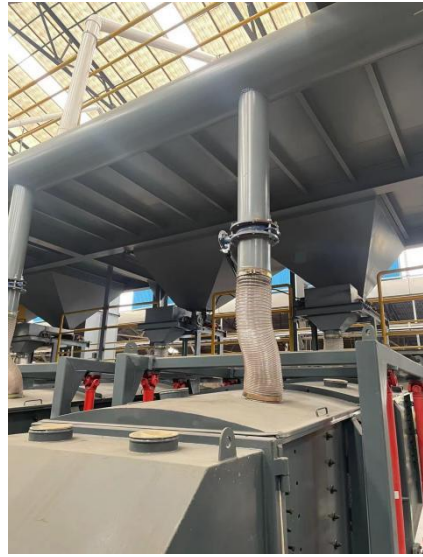
图 2 筛分机顶部设置密闭收集口
