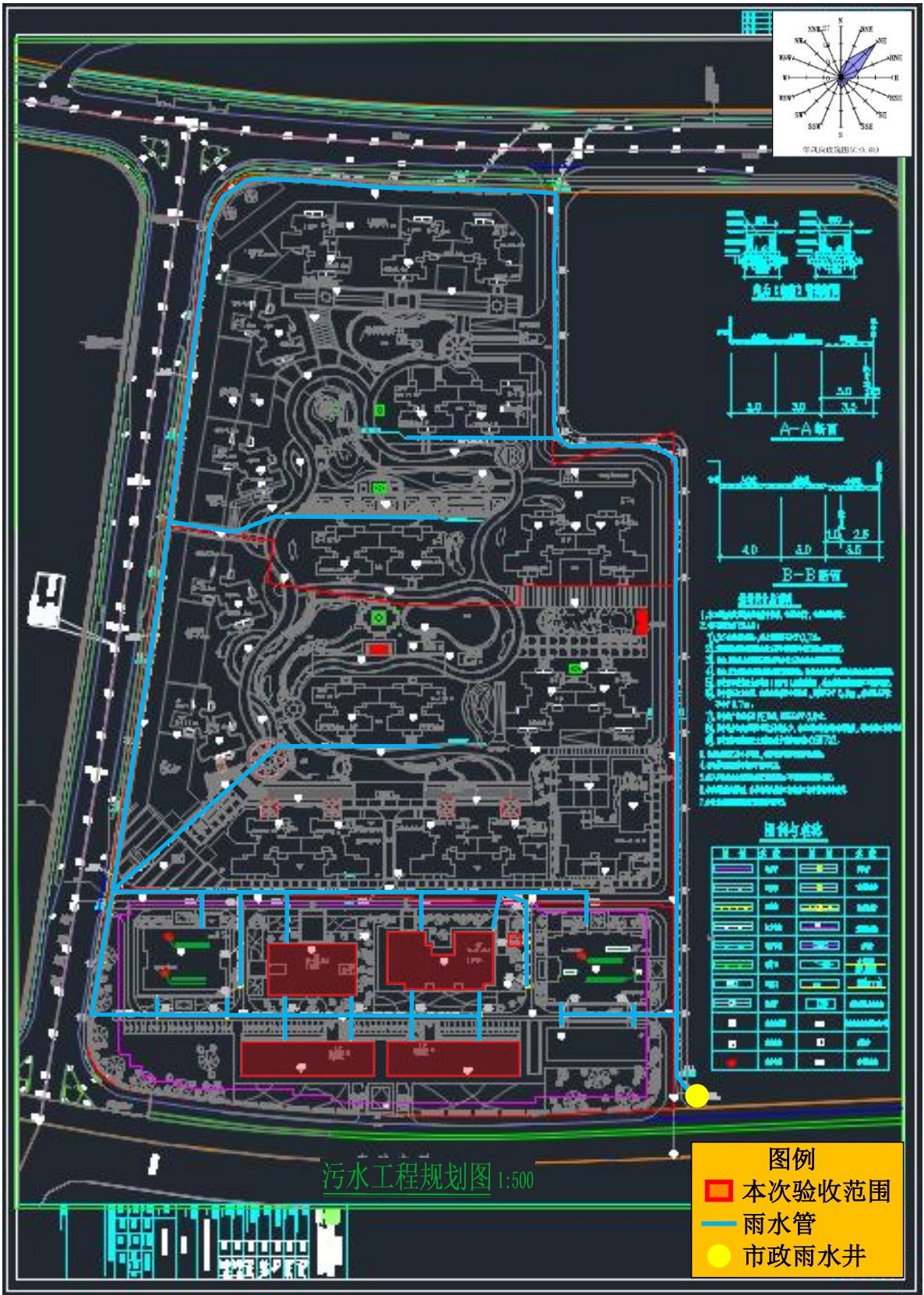
附图 5 雨水管道铺设情况
